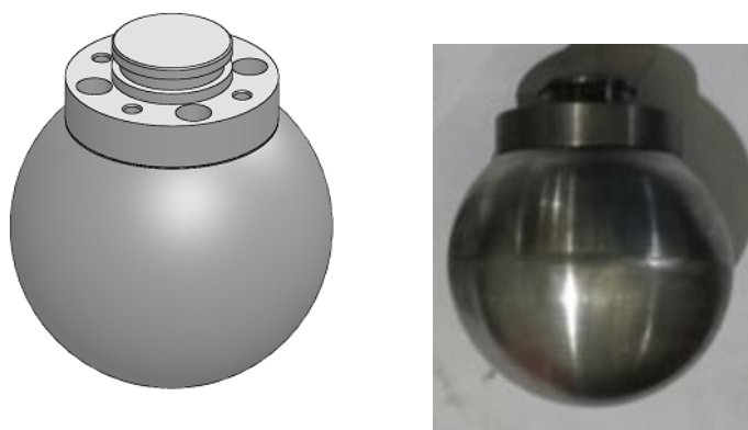
Figura 16: Esfera/Rotor que se Apoia no Estator
