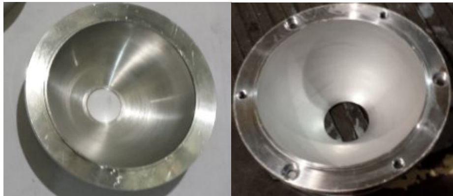
Figura 23: Estator Antes e Depois da Lapidação
