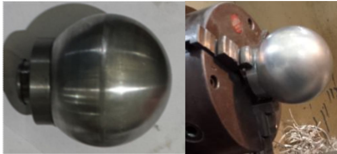
Figura 22: Esfera Antes e Depois da Lapidação
