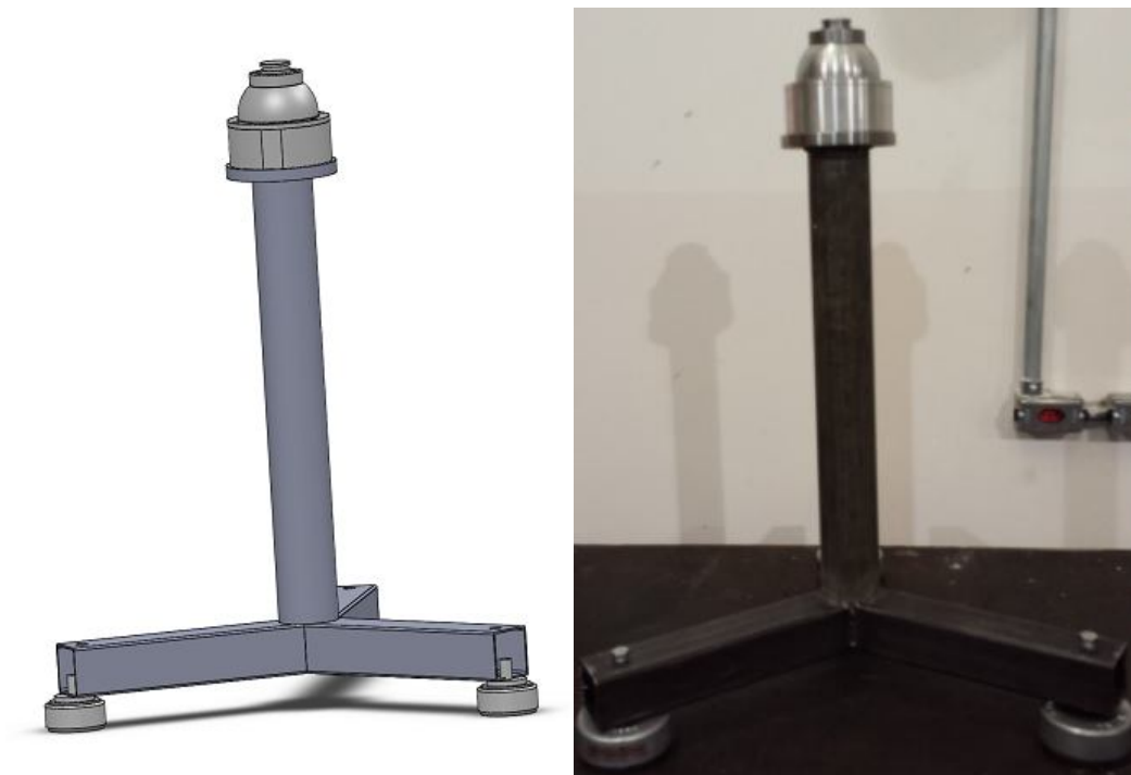
Figura 15: Haste Vertical Soldada à Base em Forma Estrela, Juntamente com Interface para o Mancal
