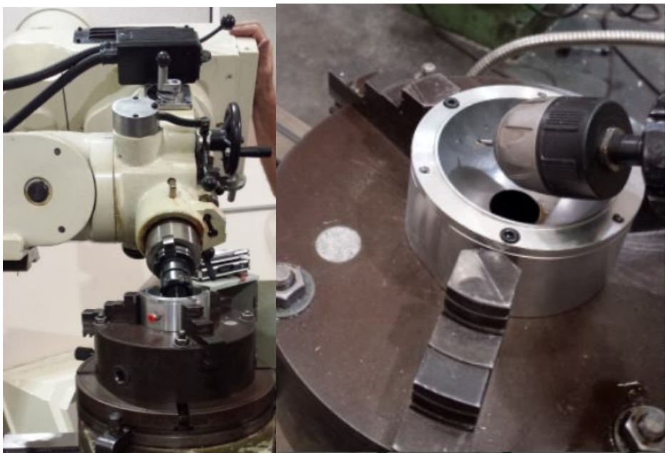
Figura 19: furação dos restritores de fluxo do mancal
