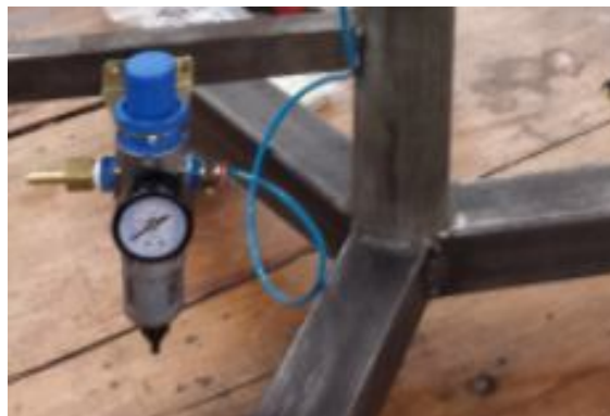
Figura 24: Manômetro Utilizado para Regular a Pressão de Alimentação do Mancal
