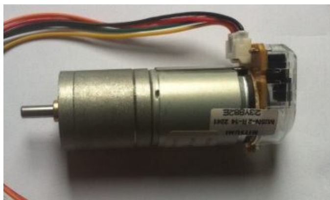
Figura 34: Da Esquerda para Direita, Redução, Motor e Encoder Conectados
