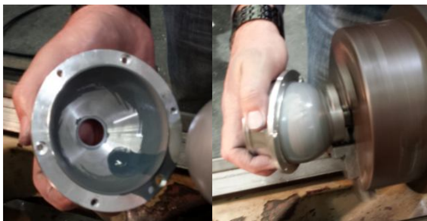
Figura 21: Lapidação da Esfera com Estator
